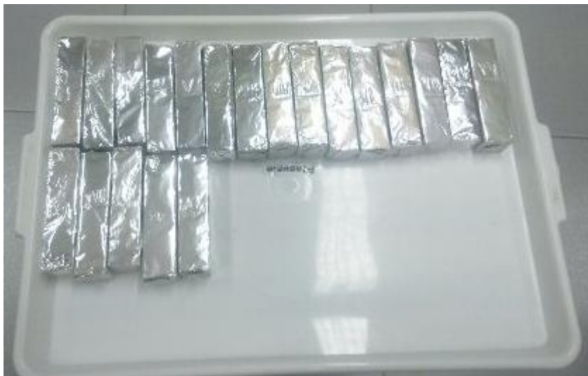
Figura 1. Corpos de Prova envoltos em Papel alumínio e devidamente identificados. Fonte: O Autor (2016).
