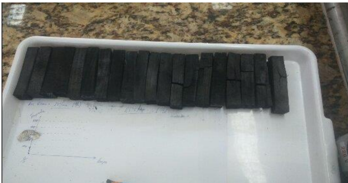
Figura 2. Corpos de Prova após processo de carbonização. Fonte: O Autor (2016).
