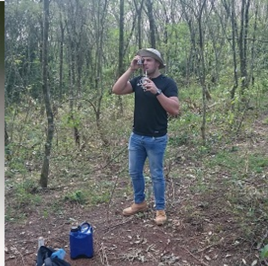
Figura 4 – Medição de altura com o Vertex IV. Fonte: O autor (2016).
