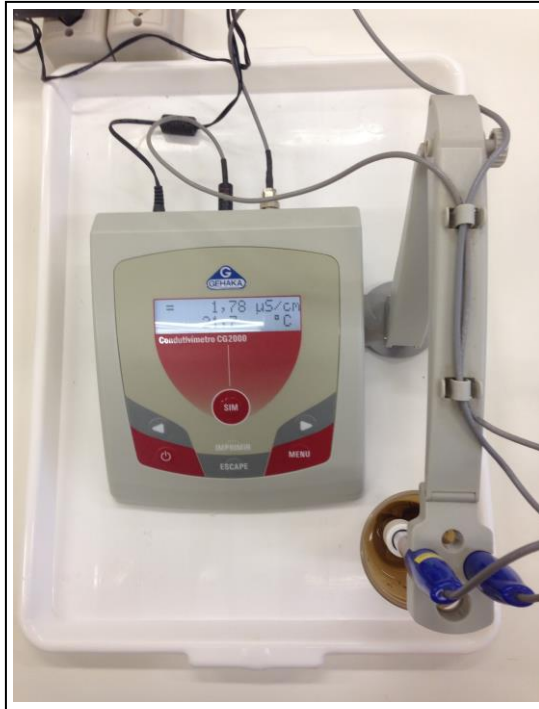
FIGURA 10: Condutividade elétrica de A. parvifolium sendo lida em condutivímetro digital. Dois Vizinhos, 2017.
