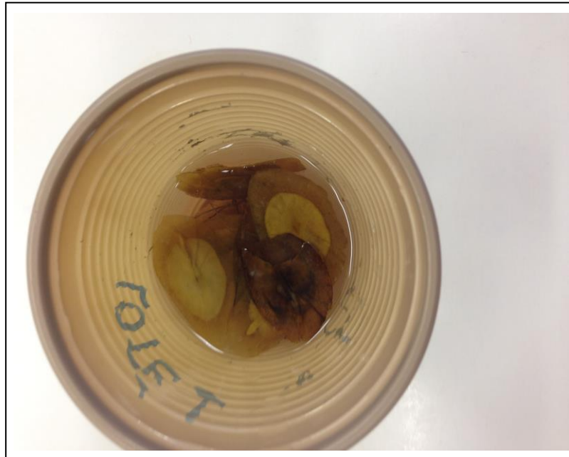
FIGURA 9: Embalagem plástica com sementes de A. parvifolium sendo embebidas para o teste de pH do exsudato de forma massal. Dois Vizinhos, 2017.
