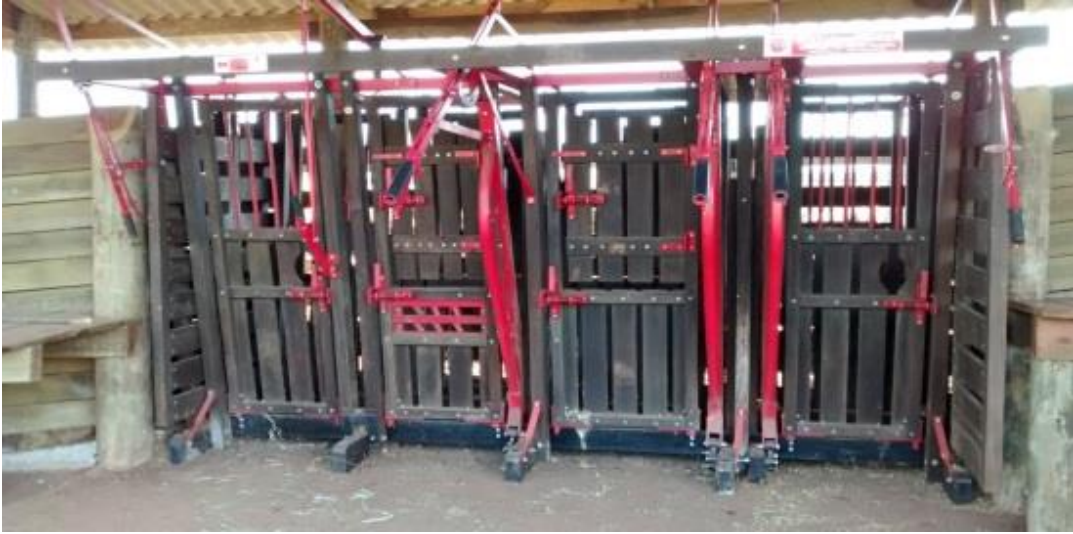
Figura 3. Brete de contenção em modelo americano, tipo 'V', em Francisco Beltrão (PR) Fonte: Zandonai (2014)
