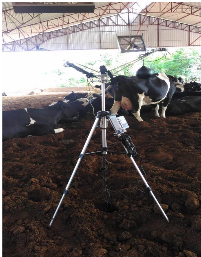
Figura 5 - Estação micrometeorológica utilizada no registro dos dados
