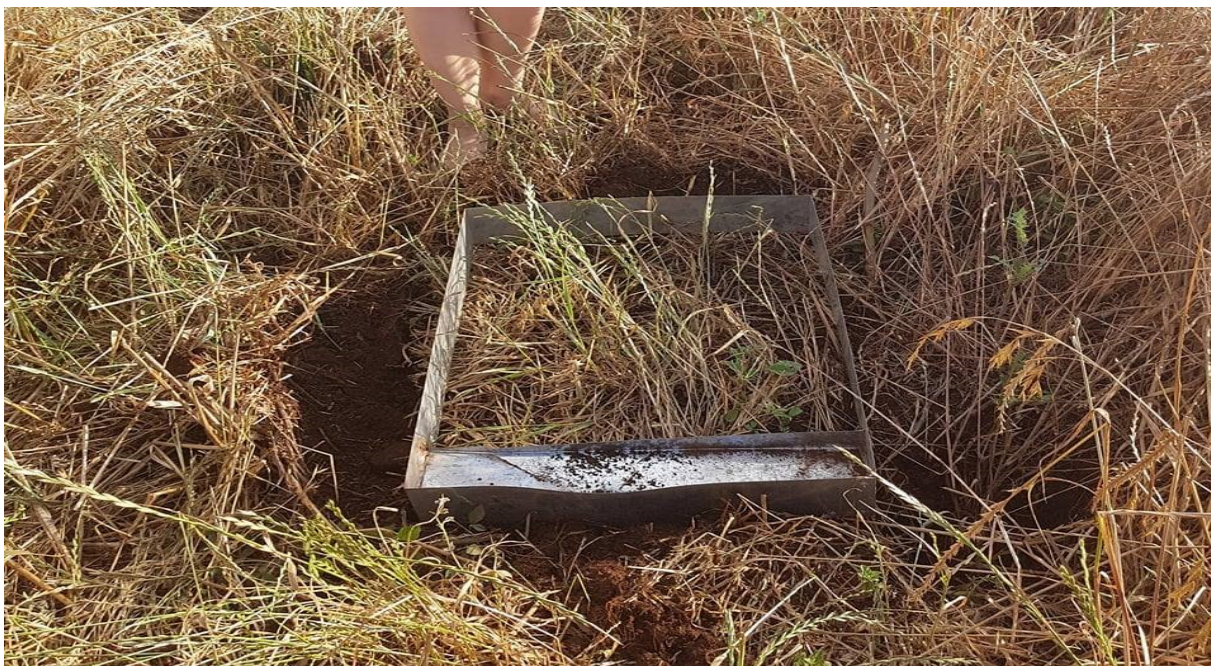
Figura 9: Instalação de calha coletora (ILP).
