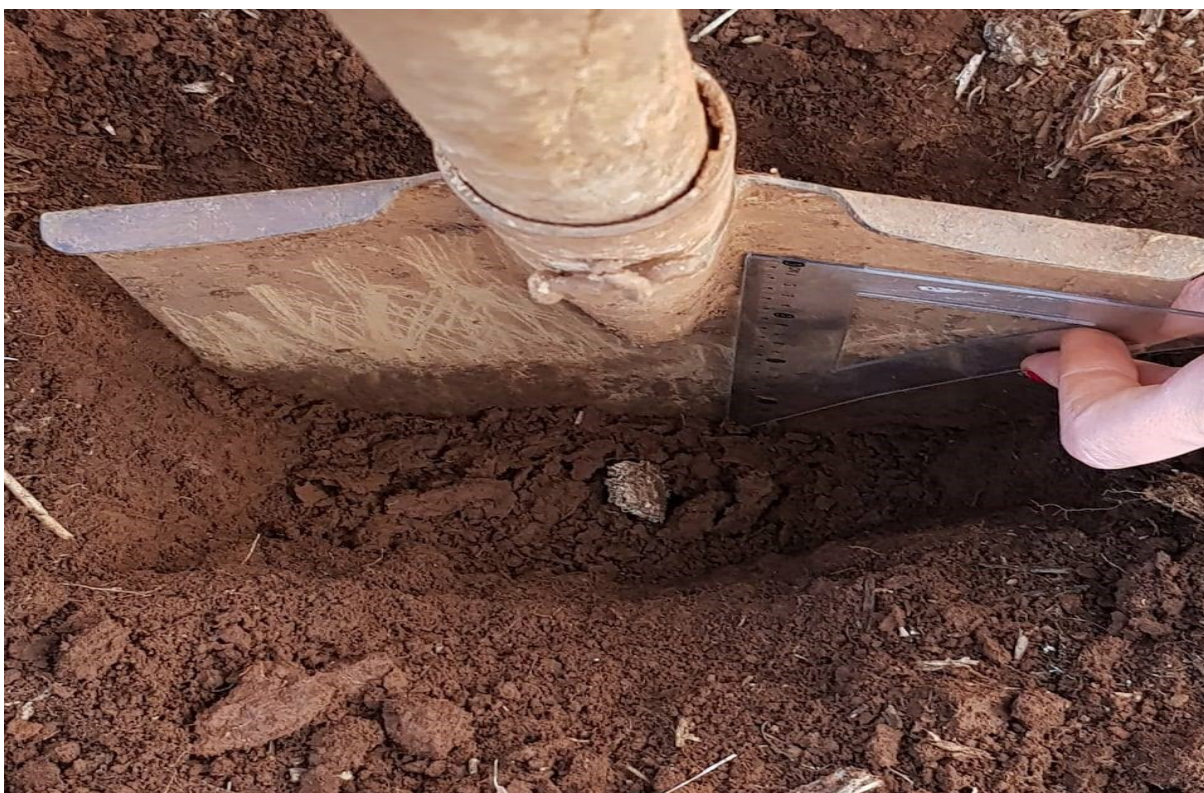
Figura 14: Medição dos 20cm de profundidade da coleta de solo para análise de M.O
