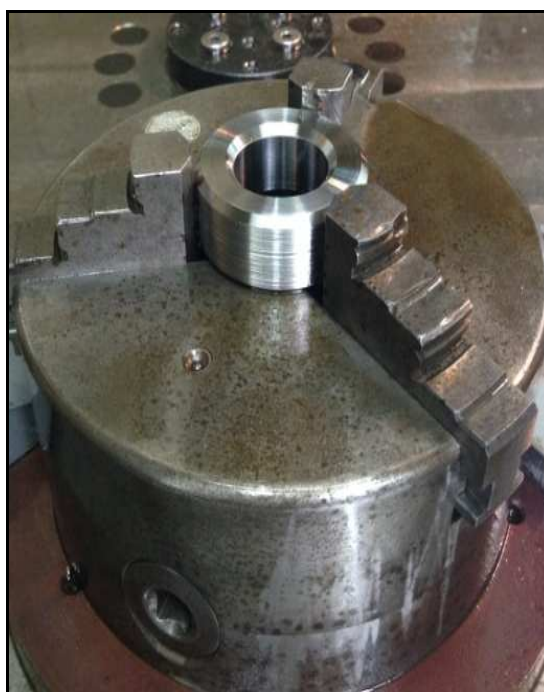
Figura 3.4 – Corpo de prova fixado à placa da máquina
