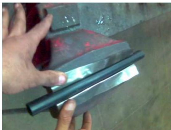
Figura 30 – Fabricação aletas de latas de alumínio
