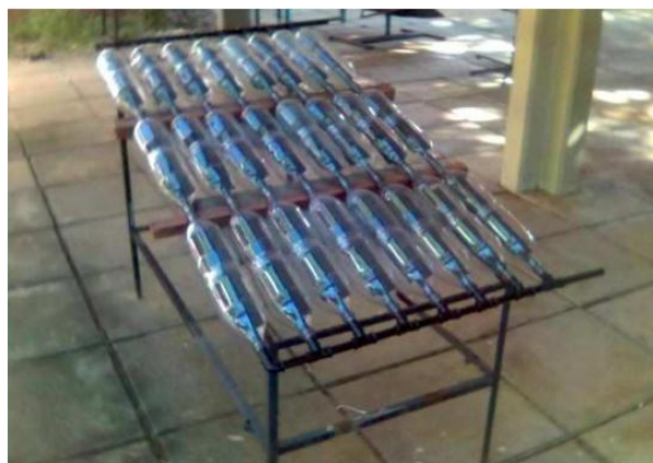
Figura 34 – Garrafas e aletas posicionadas no cano
