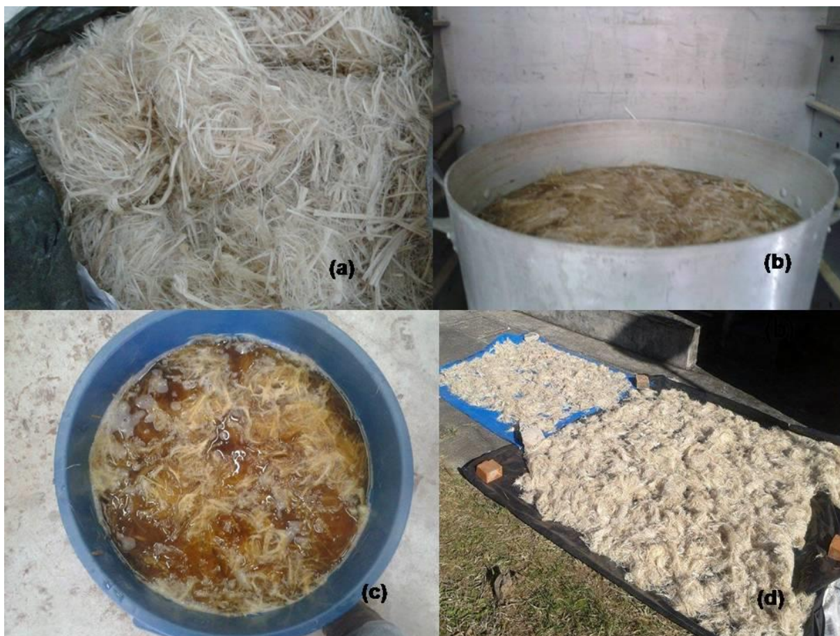
Figura 12. Fibras sem tratamento secas em estufa (a) tratamentos realizados na fibra de curauá, água quente (b), NaOH (c) e secagem ao ar livre (d).
