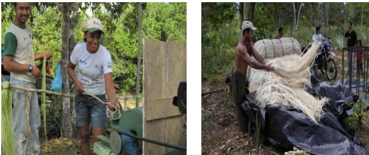
Figura 4. Processo de extração da fibra de curauá
