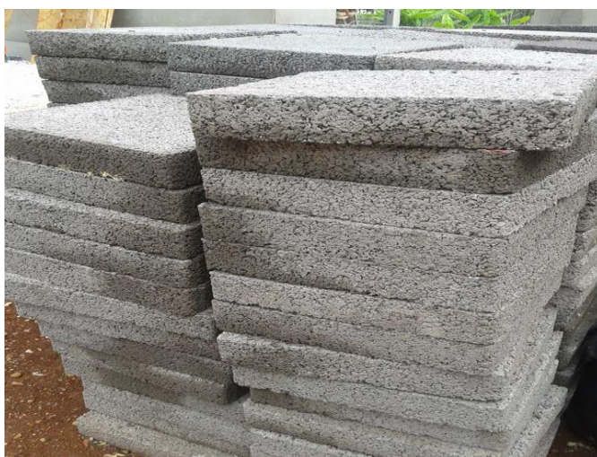
Figura 8. Painéis cimento-madeira para a construção das casas na UTFPR
