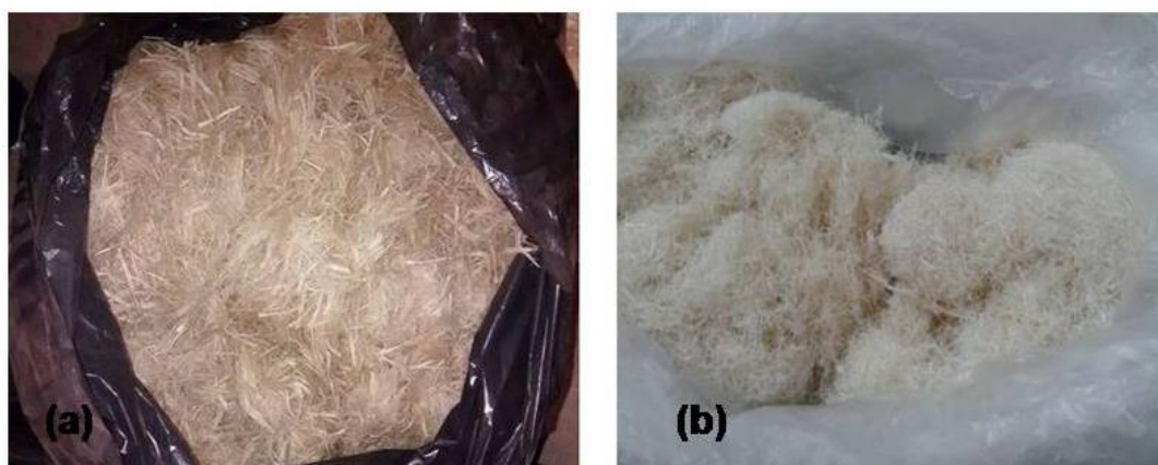
Figura 11. Fibras com 4 cm (a) e posteriormente passadas no moinho de facas (b)
