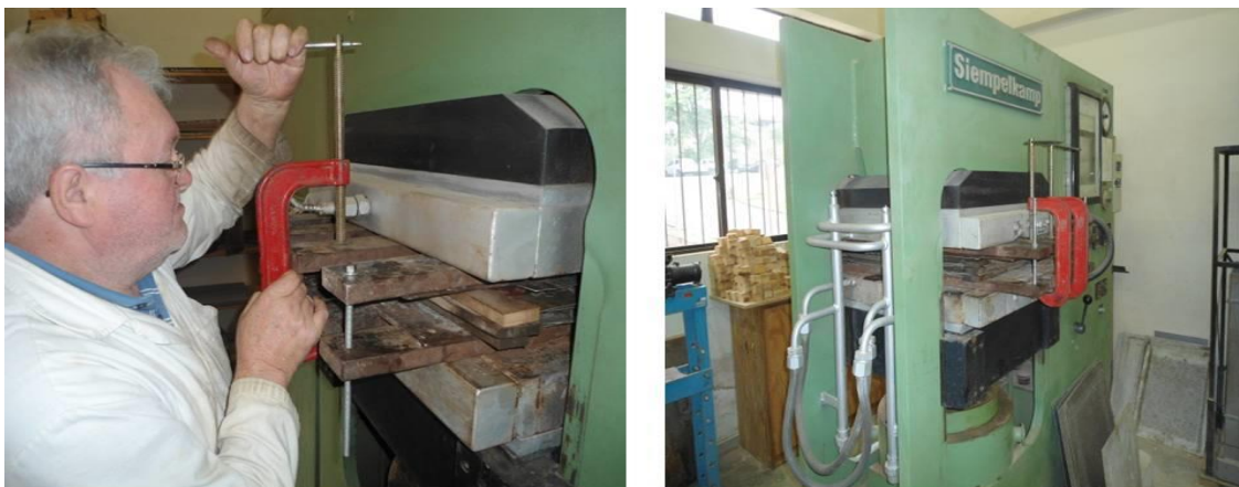
Figura 19. Processo de Montagem dos painéis
