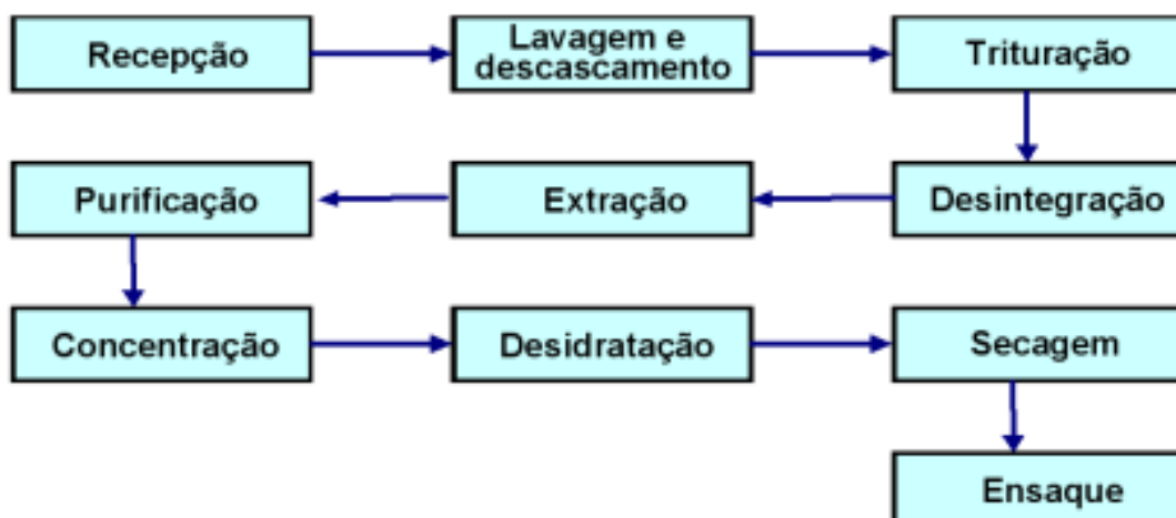
Figura 2: Fluxograma geral de processamento de amido de mandioca.
