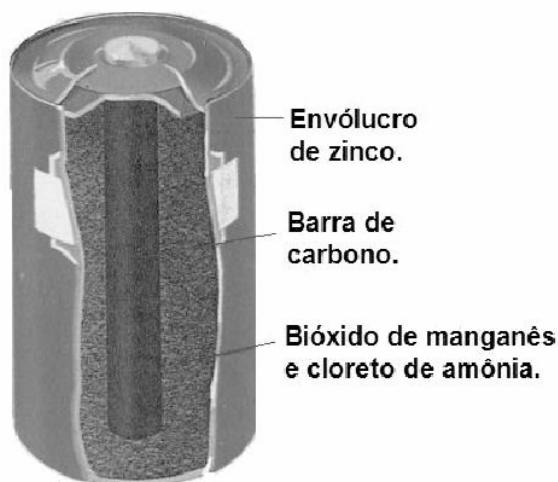
Figura 3: Ilustração do interior de uma pilha de zinco carbono
