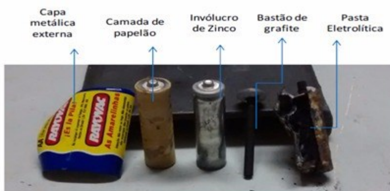
Figura 4: Esquema de uma pilha zinco/carbono aberta
