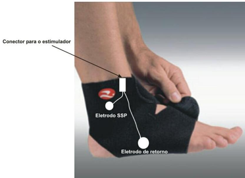
**FIGURA 13: TORNOZELEIRA COM ELETRODOS DE ESTIMULAÇÃO.
