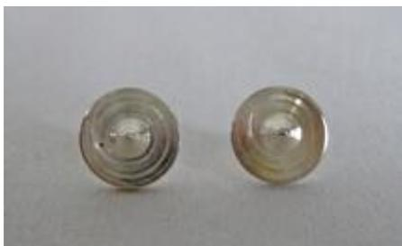
**FIGURA 12: ELETRODOS PONTO DE PRATA (*SILVER SPIKE POINT*) (SSP).**
