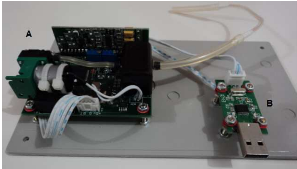
Figura 13 – Equipamento de mensuração da pressão de dióxido de carbono expirado. A: Módulo de capnografia, B: Placa conversora de RS232 para USB. Fonte: Própria.
