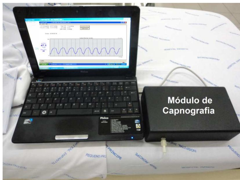
Figura 22 – Módulo de capnografia conectado a um notebook para visualização das mensurações de dióxido de carbono expirado através do software Capnostat. Fonte: Própria.
