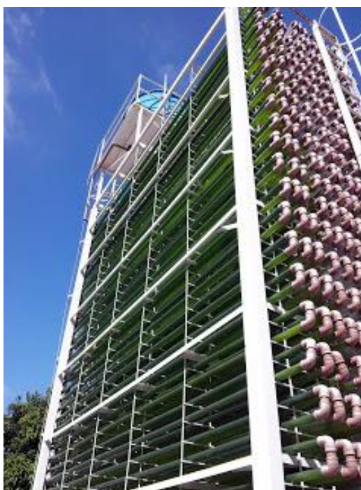
Figura 5 - Fotobiorreator tubular compacto desenvolvido pelo NPDEAS – UFPR para produção de biomassa de microalgas.
