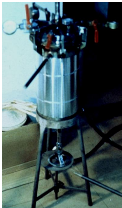
Figura 9 – Fotografia do termopressurizador utilizado para a realização das hidrólises termo-fosfóricas
