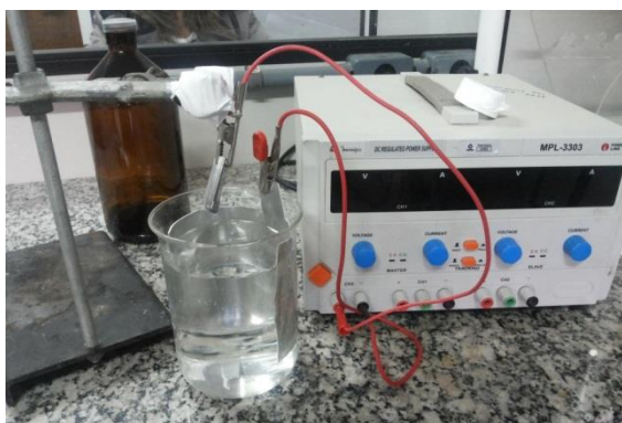
Figura 9 - Anodização das amostras Fonte: autoria própria
