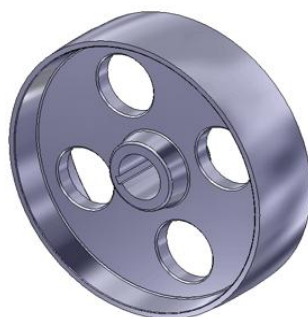
Figura 7 - Polia de face plana com abaulamento de borda Fonte: www.geocities.ws
