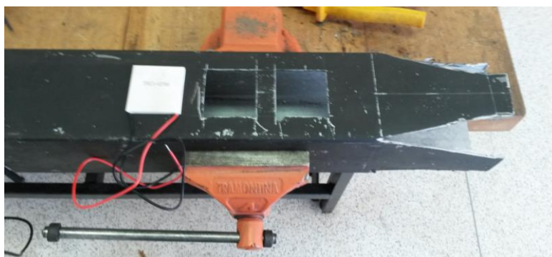
Figura 14 – Abertura para Instalação dos Módulos FONTE: Autoria Própria
