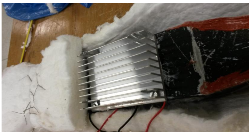
Figura 16 – Instalação das Aletas FONTE: Autoria própria
