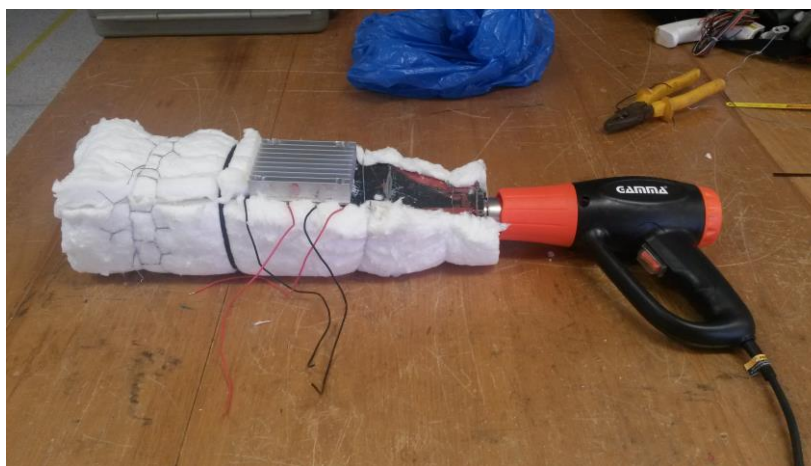
Figura 17 – Isolamento com Lã Cerâmica FONTE: Autoria própria
