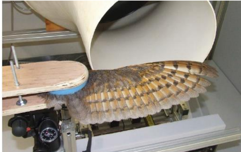
Figura 7 - Asa da coruja submetida ao túnel de vento Fonte: (GEYER et al. 2014)
