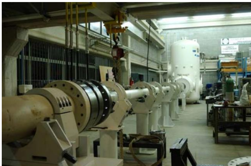
Figura 20 – Túnel de choque hipersônico T3 do Laboratório de Aerodinâmica e Hipersônica.
