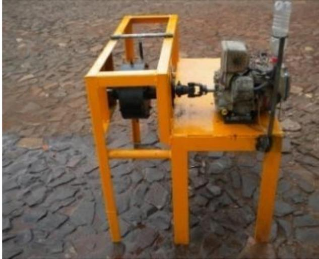
**Figura 18 - Dinamômetro instalado em bancada de testes**
