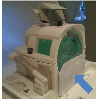
Figura 15 - Objeto de teste American College of Radiology posicionado na bobina de crânio da Ressonância Magnética Avanto da Siemens com o suporte imobilizador (indicado pela seta azul).
