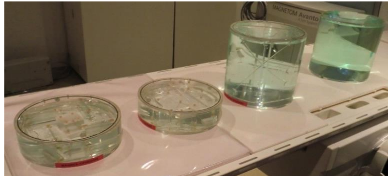
Figura 1 - Objetos de teste Eurospin TO4, TO3, TO2 e TO1 (da esquerda para a direita).
