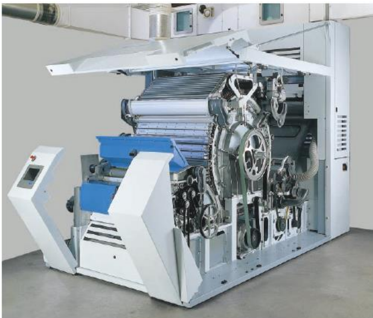
Figura 6 - Vista interna da máquina Trützschler carda TC Fonte: Catálogo da Trützschler
