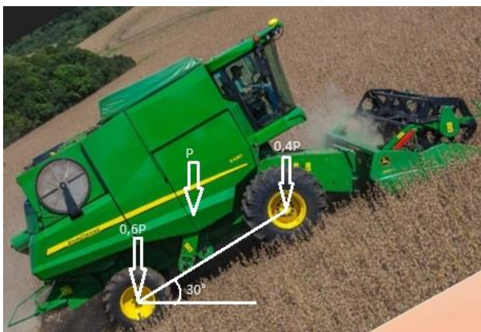
Figura 22: DCL em condição de inclinação de 30°
