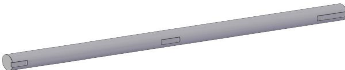
Figura 13: Eixo 2 para mancais, discos de desbalanceamentos e acoplamento.
