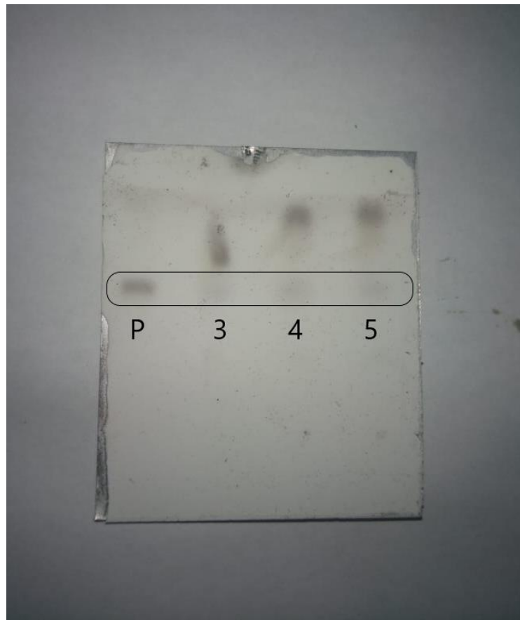
Figura 19: Placa de CCD, contendo as soluções padrão, bioóleo dos ensaios 3, 4 e 5.
