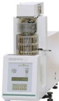
Figura 3: Analisador Termogravimétrico, Modelo TGA-51.
