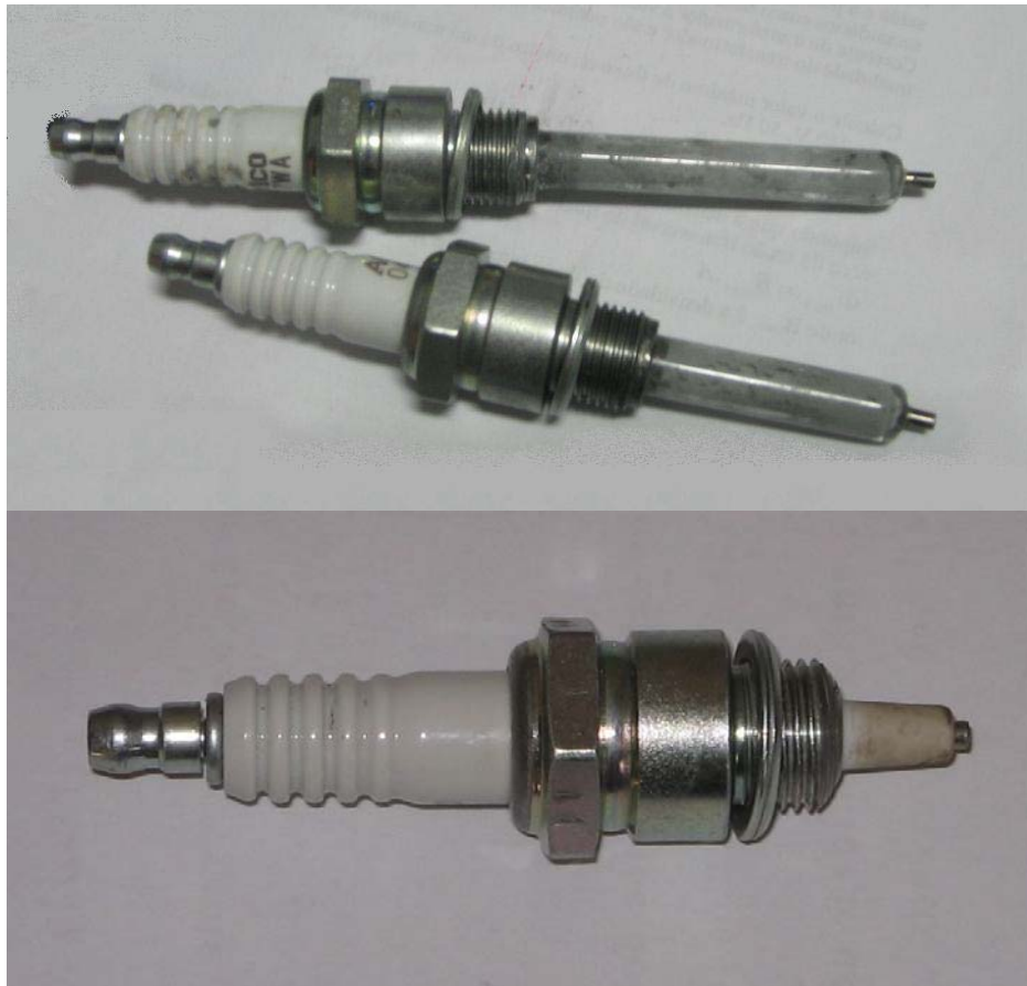
Figura 5 – Exemplos de sensor resistivo, obtidos por adaptação de velas automotivas.
