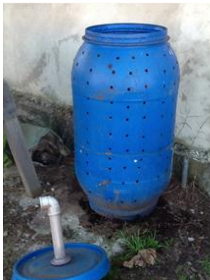
Figura 7. Bombona Plástica de 200L, toda perfurada Fonte: Autoria própria
