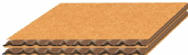
Figura 7 - Papelão ondulado de parede dupla Fonte: Tipos de papelão ondulado (ABPO, 2007, www.abpo.org.br )
