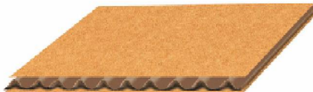
Figura 6 - Papelão ondulado parede simples Fonte: Tipos de papelão ondulado (ABPO, 2007, www.abpo.org.br )
