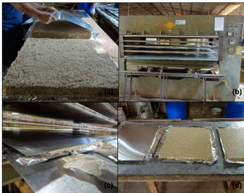
Figura 12: a) Molde de metal sobre o colchão de partículas; b) Prensa da marca SIRMAS; c) chapas já prensadas à quente e d) chapas já prensadas, aguardando chegar à temperatura ambiente.
