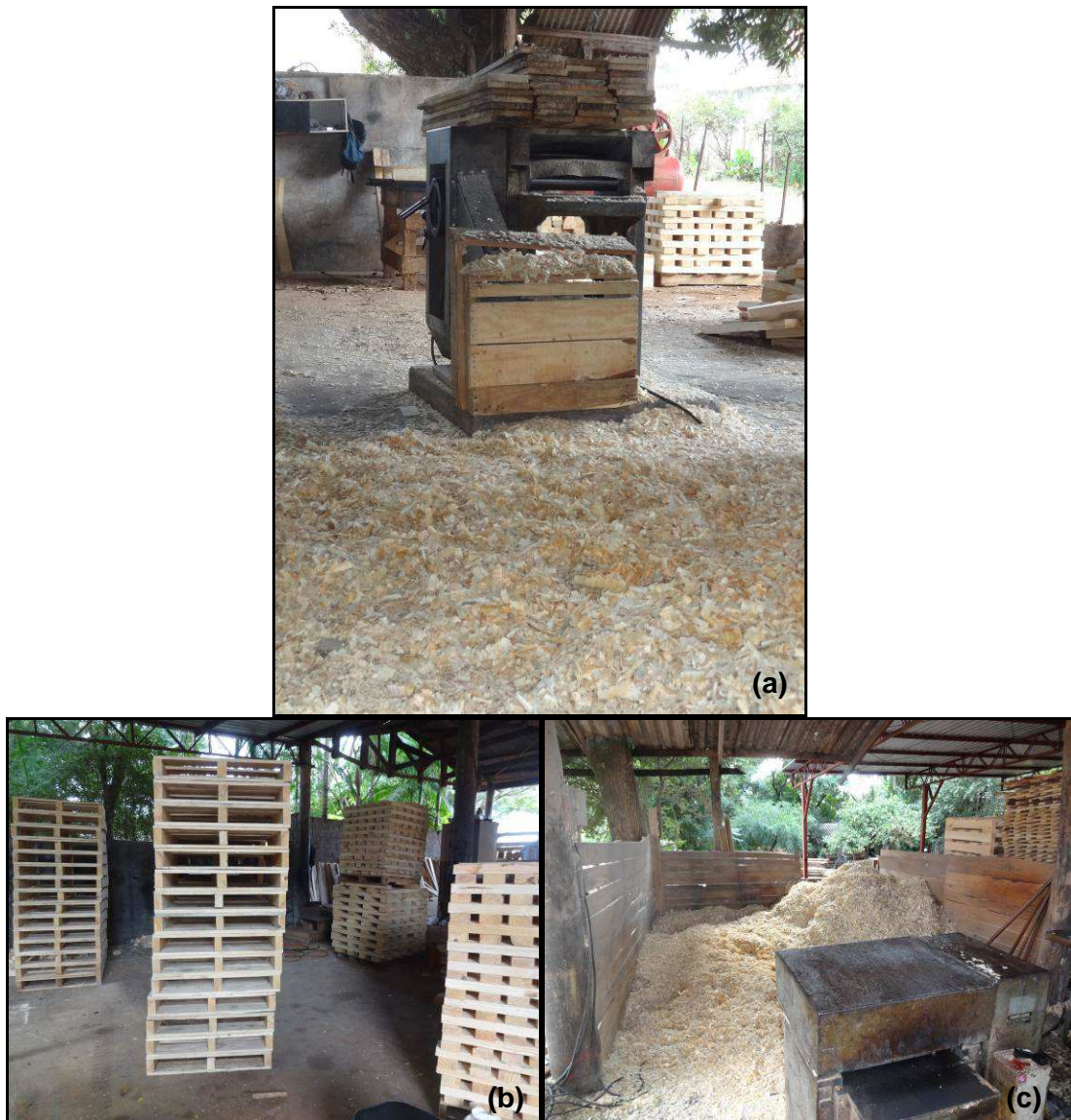
Figura 6: a) Plaina para o processamento de madeira; b) Pallets de madeira e c) Sobras de maravalhas do processamento da madeira.
