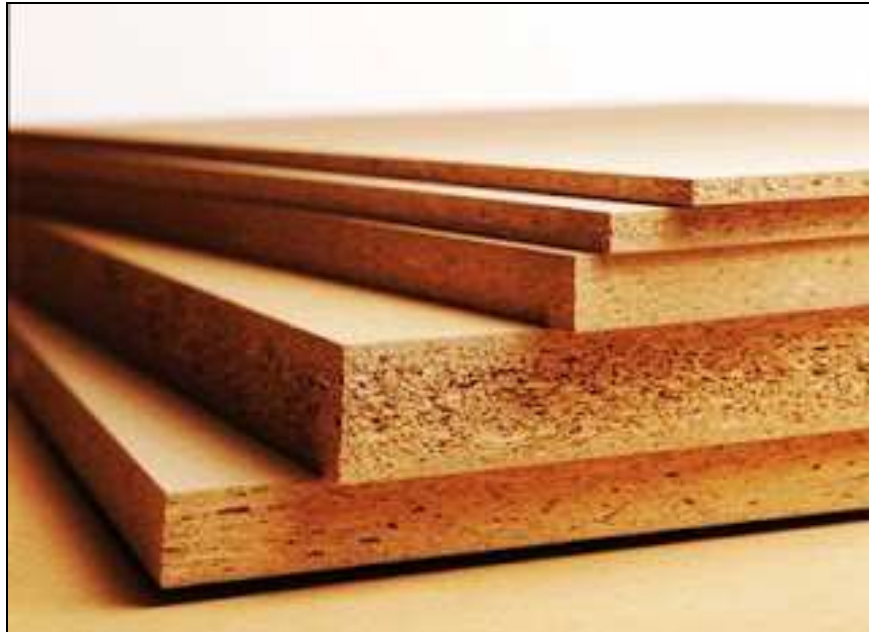
Figura 3: Painéis de Madeira Aglomerada - MDP Fonte: Móveis casa verde, 2011.
