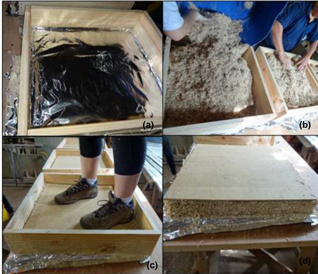
Figura 11: a) Molde de madeira sobre o molde de metal; b) distribuição da mistura dentro do molde; c) pré prensagem do colchão de partículas e d) partículas sem o molde de madeira antes de ir para a prensa.
