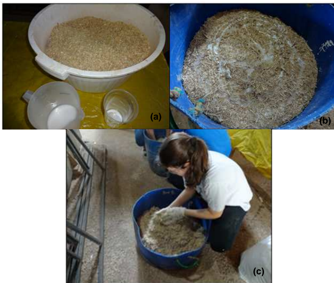
Figura 10: a) Bagaço de cana e maravalha, resina com catalisador e emulsão de parafina; b) Adição da resina com catalisador e emulsão de parafina às partículas e c) mistura manual.
