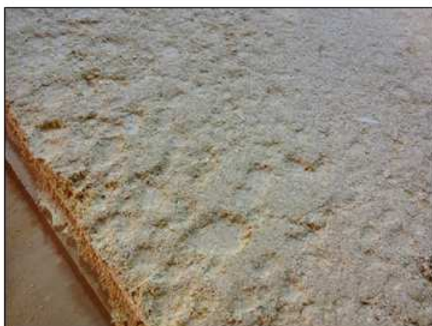
Figura 17: Aparecimento de bolhas no painel Fonte: SILVA (2013) – Qualificação, tese de doutorado.
