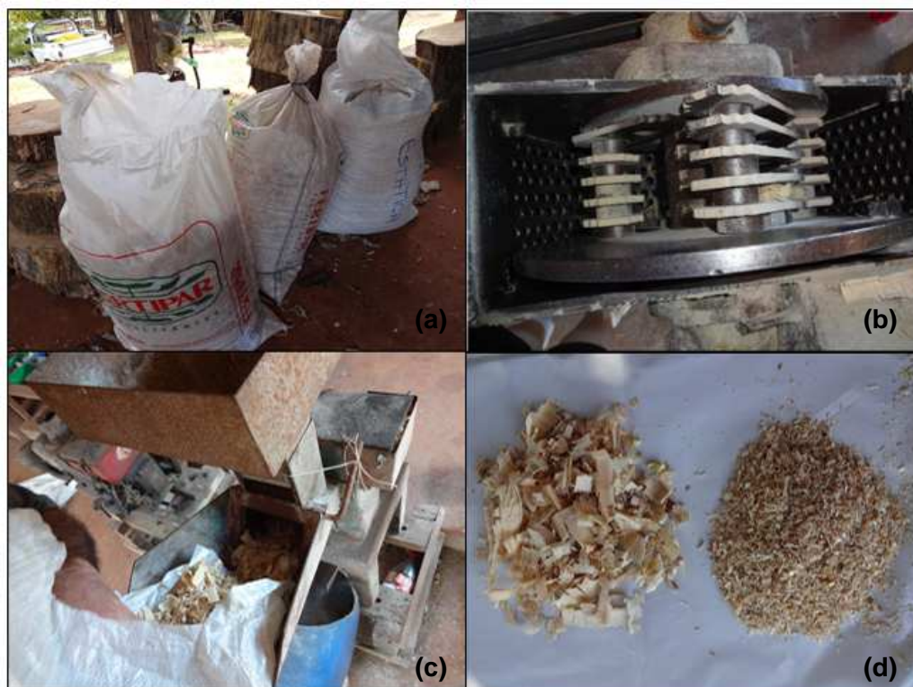
Figura 7: a) Maravalha ensacada; b) Peneira no interior do triturador; c) Triturador; e d) Maravalha antes e depois de triturar.
