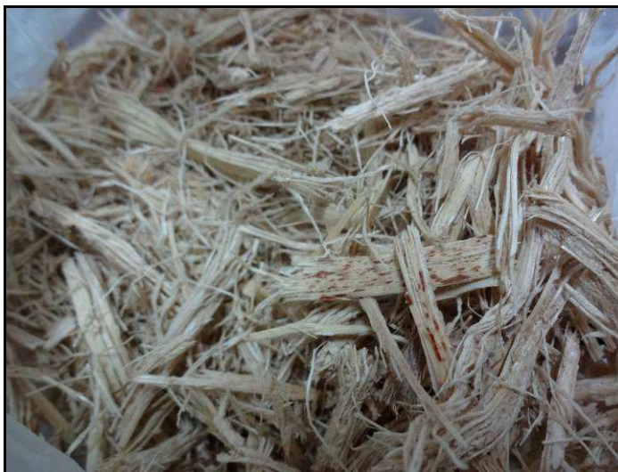
Figura 1: Bagaço da Cana de Açúcar – Usina Santa Terezinha, Maringá-PR
