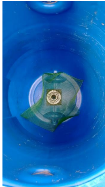
Figura 8 – Tela colocada na entrada do coletor de lixiviado.
