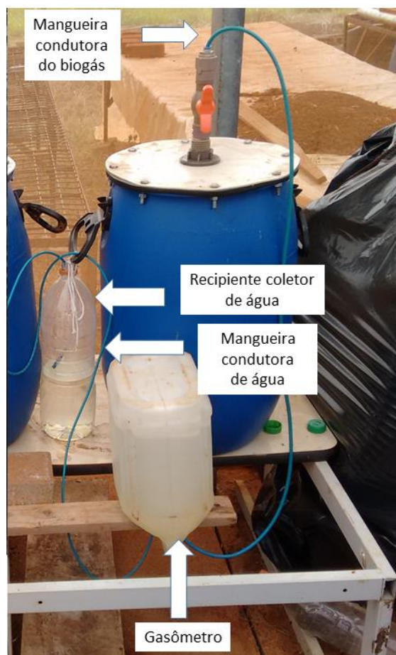
Figura 9 – Sistema de medição da quantidade de biogás gerado.
