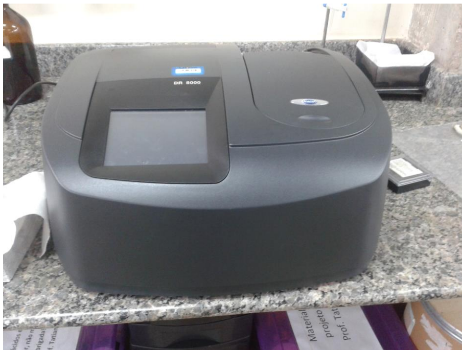
Figura 13: Espectrofotômetro DR 5000 utilizado na determinação de P. Fonte: autoria própria.
