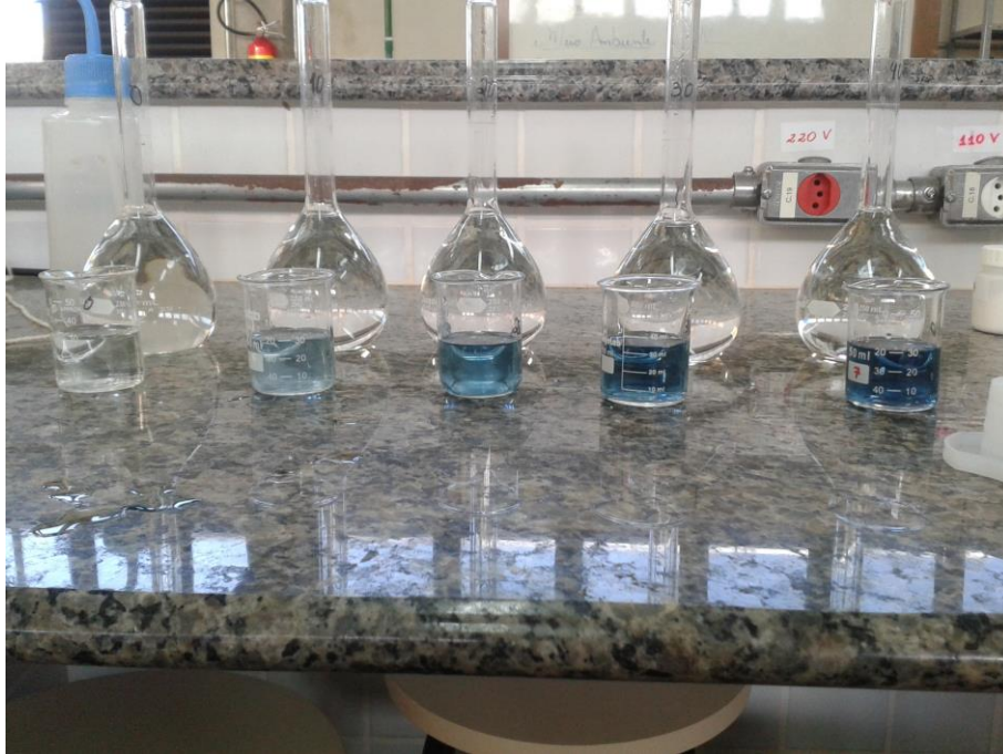
Figura 14: Soluções para obtenção da curva de Fosforo. Fonte: Aatoria própria.
