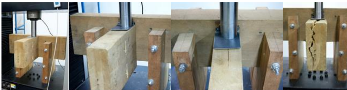
Figura 27 – Sequência da aplicação da carga e o comportamento do modelo B1 (8,0 cm x 20,0 cm, com Chapa). Fonte – Autoria própria.
