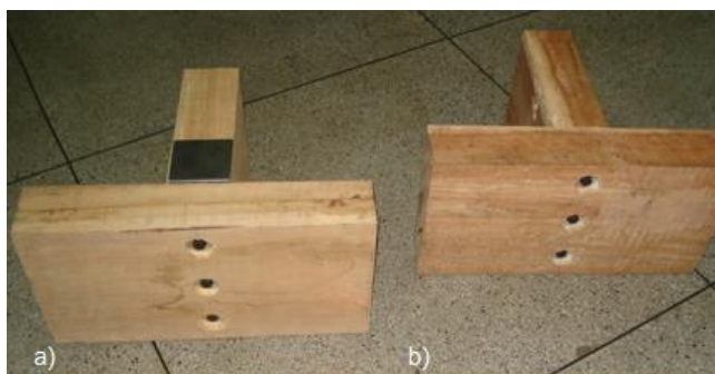
Figura 22 – Modelos 10,0 cm x 30,0 cm, com três parafusos: a) A2, com chapa; b) B2, sem chapa. Fonte – Arquivo do autor.
