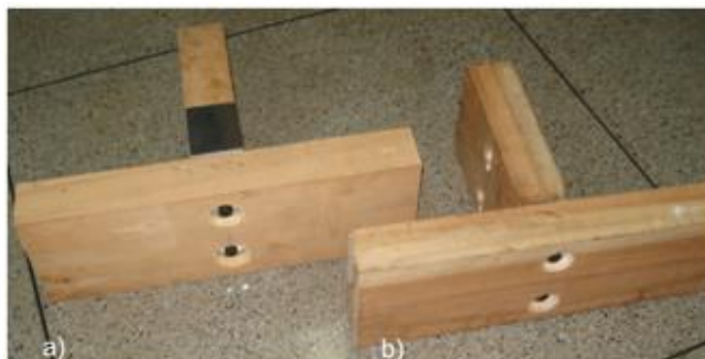
Figura 21 – Modelos 8,0 cm x 20,0 cm, com dois parafusos: a) B1, com chapa; b) A1 sem chapa. Fonte – Arquivo do autor.
