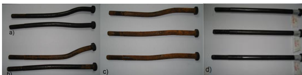
Figura 30 – Deformação dos parafusos dos A1, B1, A2 e B2: (a) B1, com chapa; (b) A1, sem chapa; (c) A2, sem chapa; (d) B2, com chapa.
