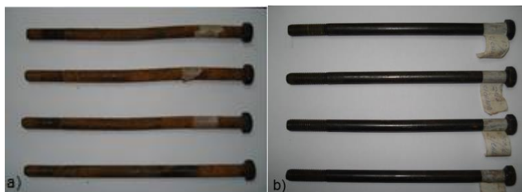
Figura 31– Deformação dos parafusos dos modelos A3 e B3: a) A3, sem chapa; b) B3, com chapa. Fonte – Autoria própria.
