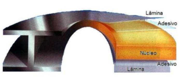
**Figura 1 - Comparação de um painel sanduíche a uma viga em I.**
