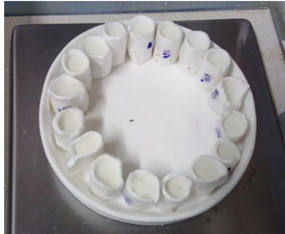
Figura 13 – Grânulos vertidos nos cadinhos de alumina
