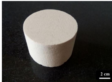
Figura 11 – Espuma cerâmica sinterizada a 1350°C
