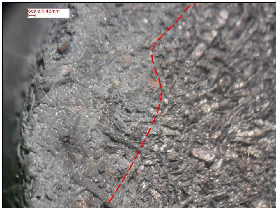
Figura 20 - Estereoscopia da amostra sinterizada em atmosfera oxidante.
