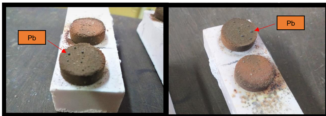
Figura 18 – Fase de chumbo precipitada na forma de gotículas na superfície das amostras.
