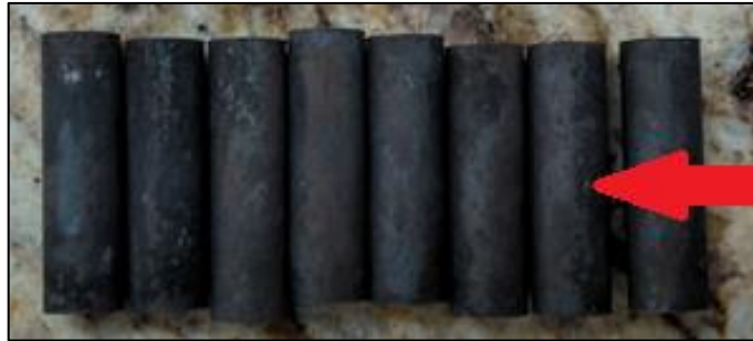
Figura 13 – Descarbonetação superficial verificada após o tratamento térmico.
