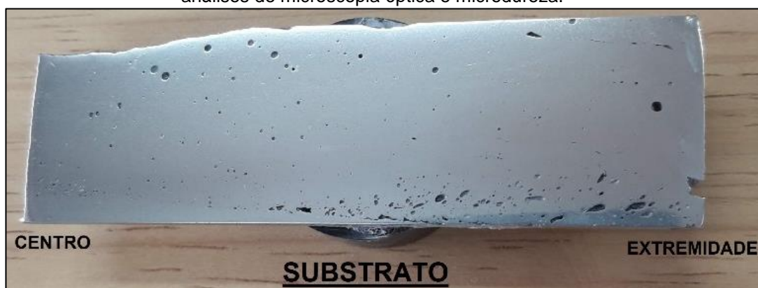
Figura 10 – Amostra da liga Al-Zn-Mg-Si-Cu no seu estado como depositada usada para análises de microscopia óptica e microdureza.
