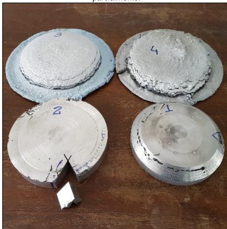
Figura 11 – Detalhe de quatro depósitos obtidos por conformação por spray . Dois deles estão usinados parcialmente.
