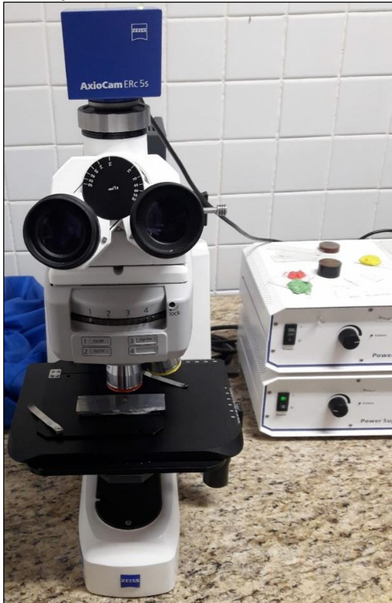
Figura 7 – Microscópio óptico da marca ZEISS acoplado de uma câmera digital AxioCam ERc 5s localizado na UTFPR em Londrina.
