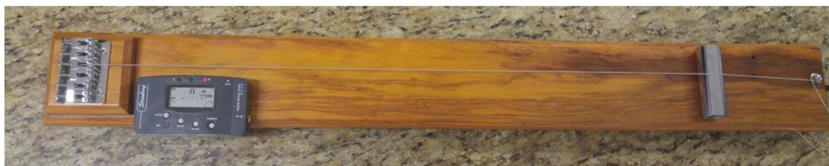
Figura 15 – Aparato criado para utilização do captador no osciloscópio, assim como o afinador à esquerda, durante a afinação em Lá (A). Fonte: Autoria própria.
