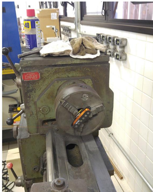
Figura 12 – O captador enrolado com cobre durante o processo de enrolamento no torno mecânico.
