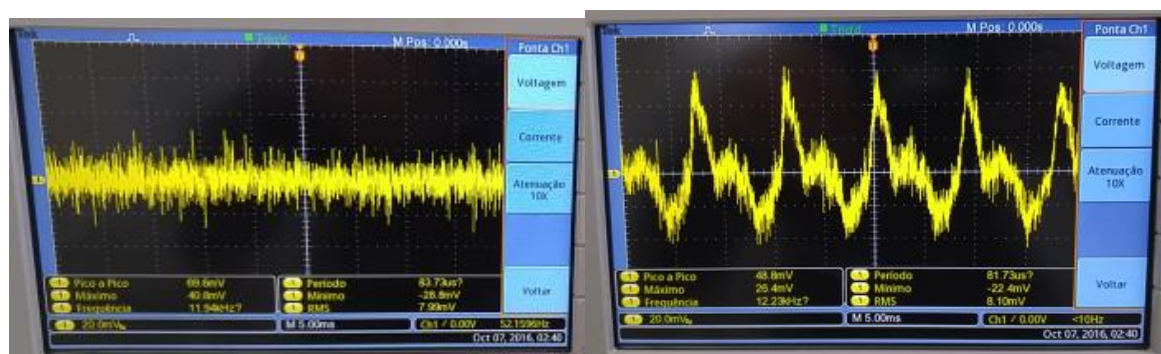
Figura 18 – Fotografia da tela do aparelho, mostrando o comportamento da tensão emitida pelo captador 150, à esquerda sem qualquer oscilação na corda, e à direita com a oscilação da corda.
