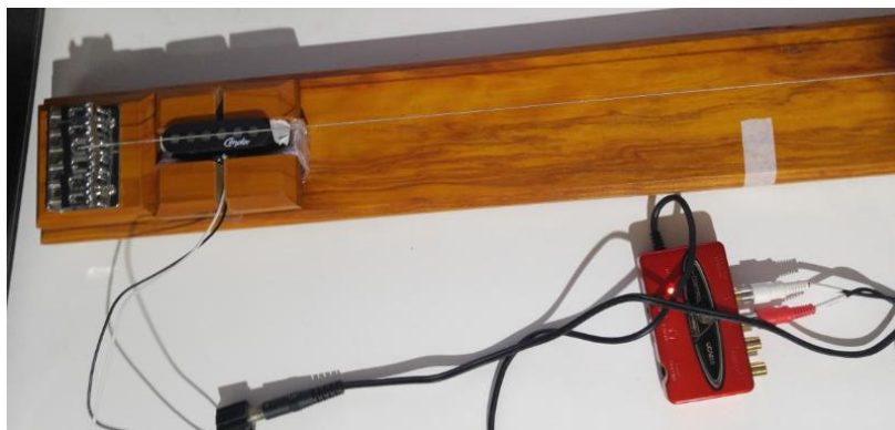
Figura 20 – Interface USB, em vermelho, o aparato e o captador posicionado próximo a ponte. Fonte: Autoria própria.
