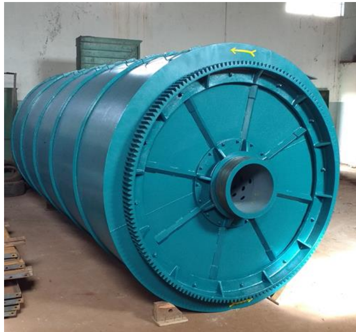
Figura 1 - Câmara de secagem do secador rotativo horizontal.
