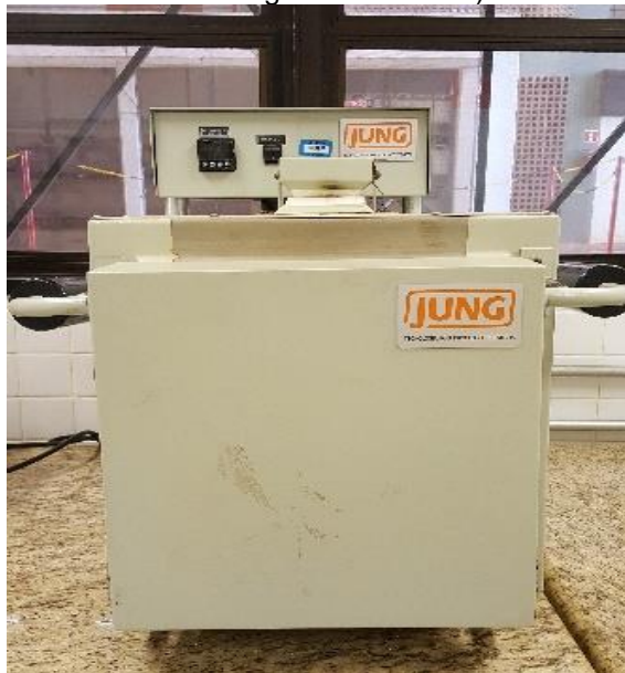
Figura 14 - Forno para a realização dos tratamentos térmicos (Marca: Jung /Modelo: 1712).
