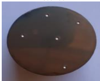
Figura 24 - Pontos da medida de dureza no material recozido.
