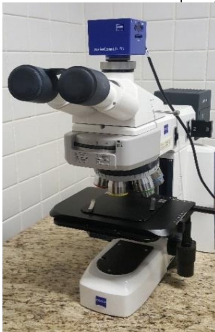
Figura 15 - Microscópio óptico para a realização das microestruturas (Marca: Zeiss/modelo: Scope A1).
