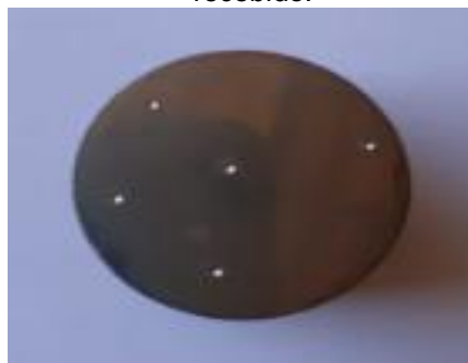
Figura 20 - Pontos da medida de dureza no material recozido, como recebido.
