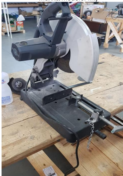
Figura 13 - Serra rápida portátil, sem refrigeração (marca: Makita/Modelo: Mt)
