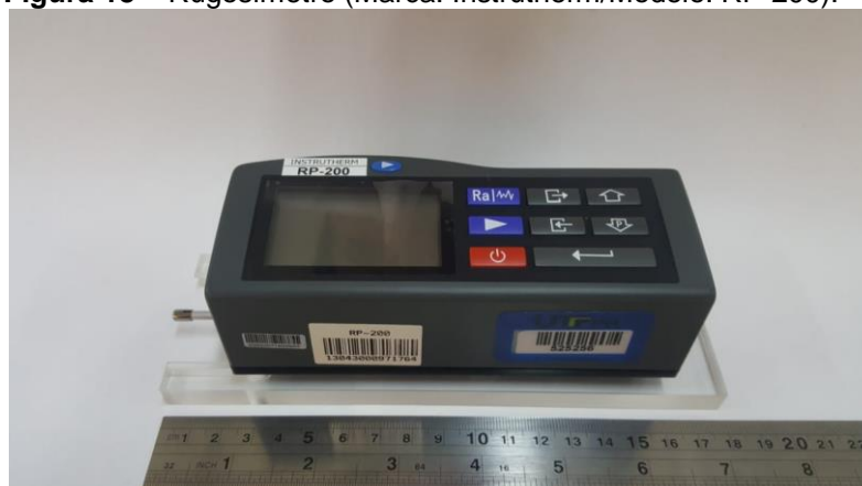
Figura 18 – Rugosímetro (Marca: Instrutherm/Modelo: RP-200).
