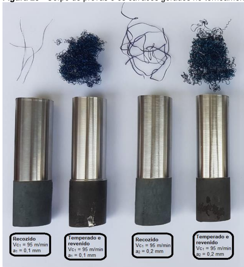
Figura 25 - Corpo de provas e os cavacos gerados no torneamento.
