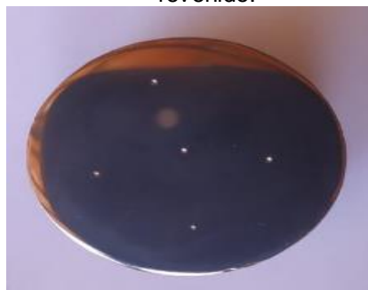
Figura 22 - Pontos da medida de dureza no material temperado e triplo revenido.
