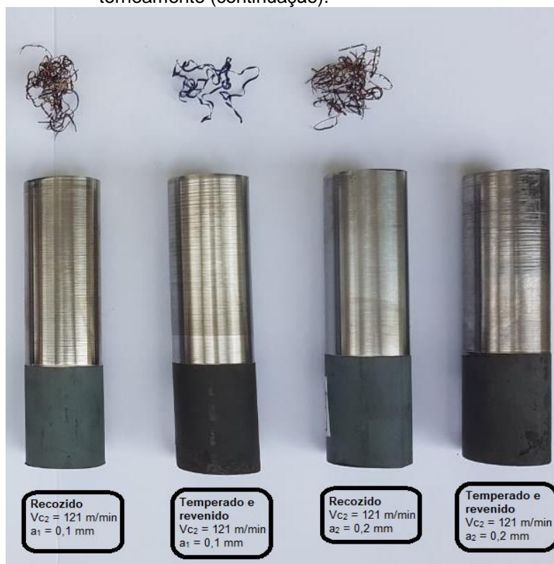
Figura 26 - Corpo de provas e os cavacos gerados no torneamento (continuação).
