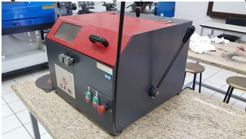
Figura 12 – Cortadora metalográfica (Marca: Fortel/Modelo: CF III).
