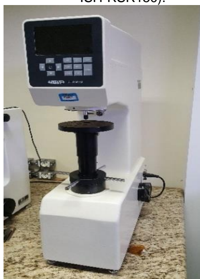
Figura 16 – Durômetro (Marca: INSIZE /Modelo: ISH-RSR150).
