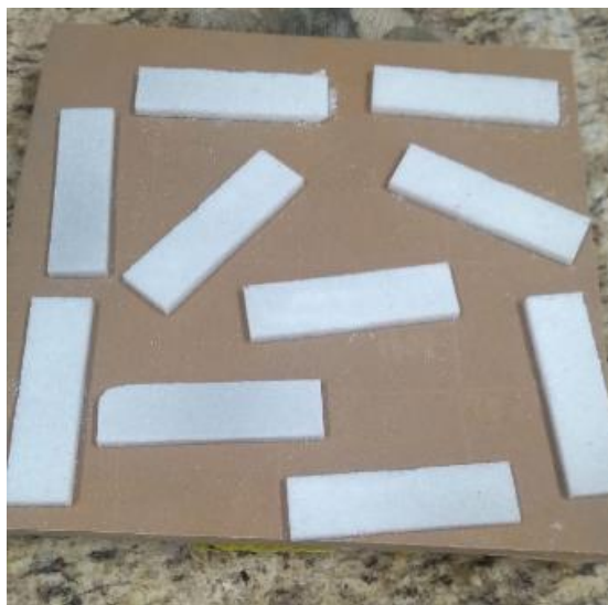
Figura 15: Membranas após o processo de sinterização.
