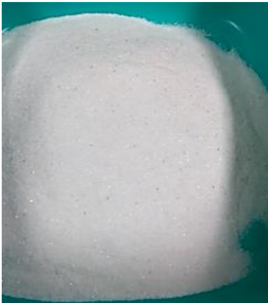
Figura 12: Foto do pó de vidro retido na peneira de 80 Mesh.
