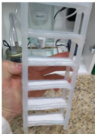
Figura 18: Forma de acoplamento das membranas no porta membranas.
