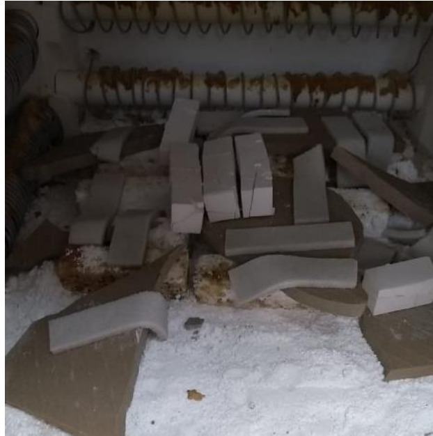
Figura 14: Falha do suporte durante o processo de sinterização.
