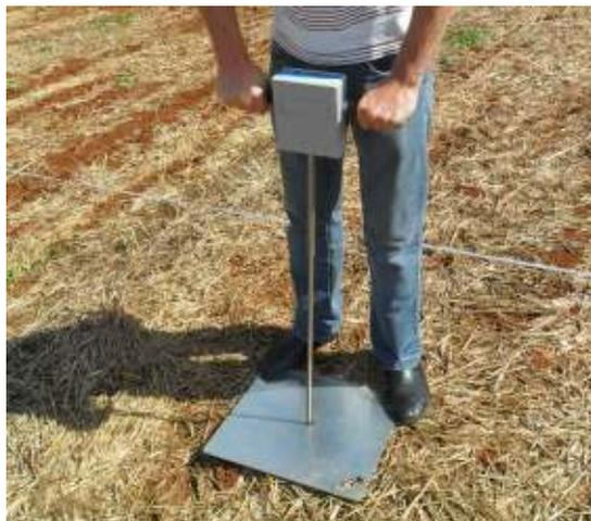
Figura 4 - Coleta dos dados de resistência mecânica do solo à penetração. Pato Branco - PR, 2015.
