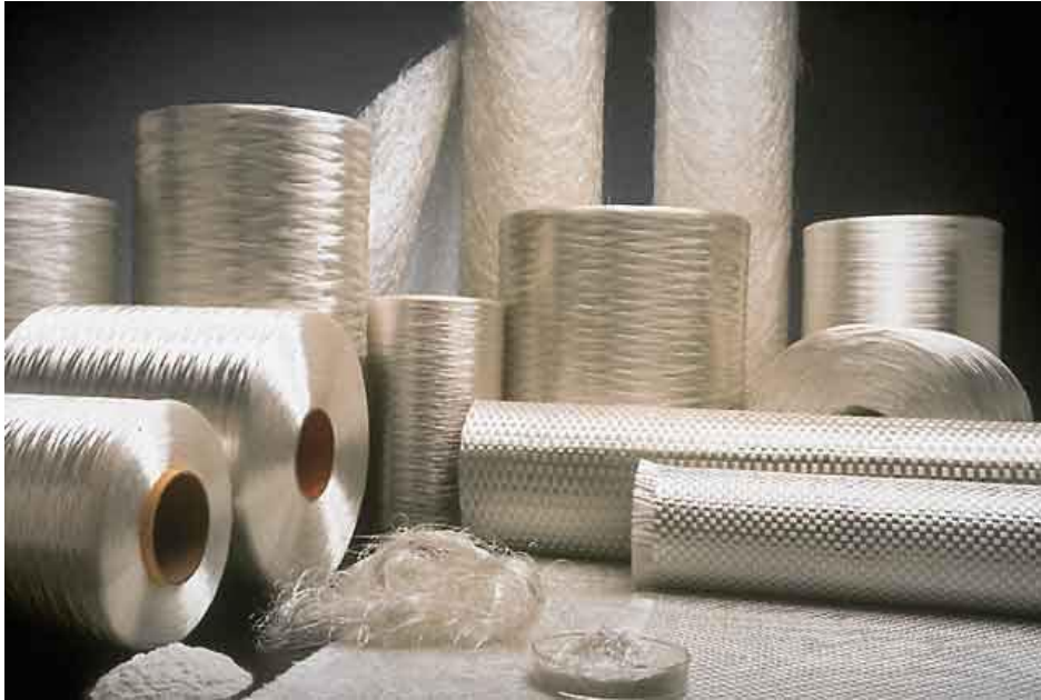
Figura 12 - Vidro nas formas típicas de reforço: roving , tecidos bidirecionais e mantas de fibras longas e curtas.
