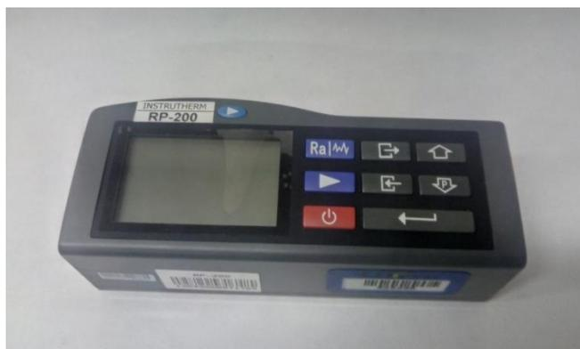
**Figura 8. Rugosímetro Instrutherm RP-200.**
