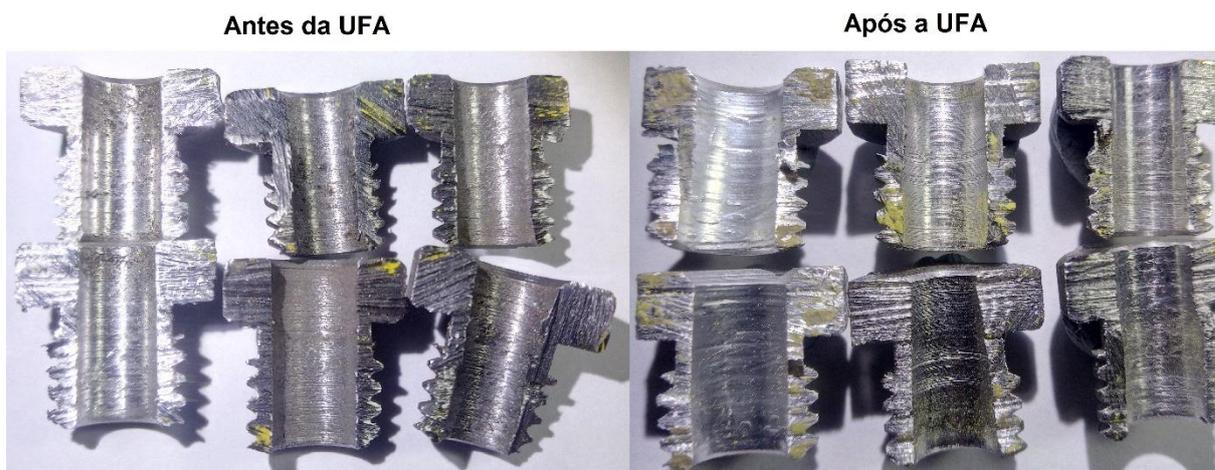
**Figura 15. Superfície interna dos corpos de prova antes e depois da UFA.
