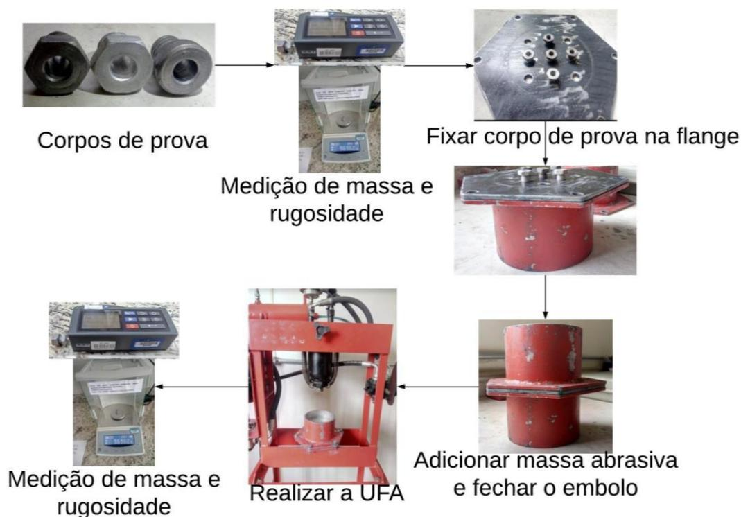
**Figura 9. Fluxograma do procedimento experimental.**
