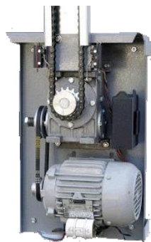
Figura 1 - Dispositivo para acionamento de portão Fonte: Autor desconhecido 1
