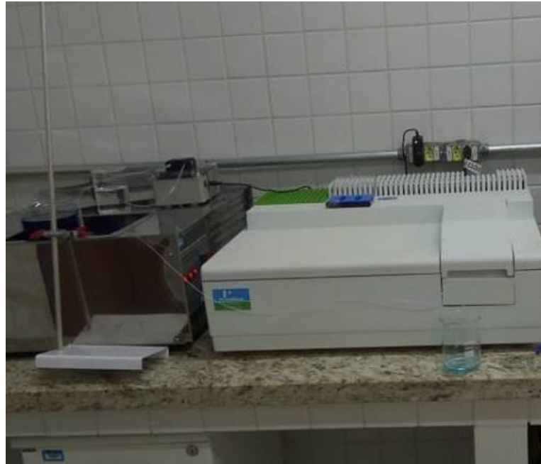
Figura 7: Imagem digitalizada do aparato experimental utilizado nos estudos de adsorção em leito fixo de azul de metileno em C.A de borra de café.
