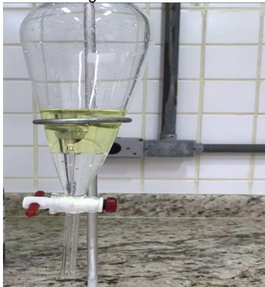
Figura 13 - Funil de separação entre a fase aquosa da fase orgânica da bebida energética.
