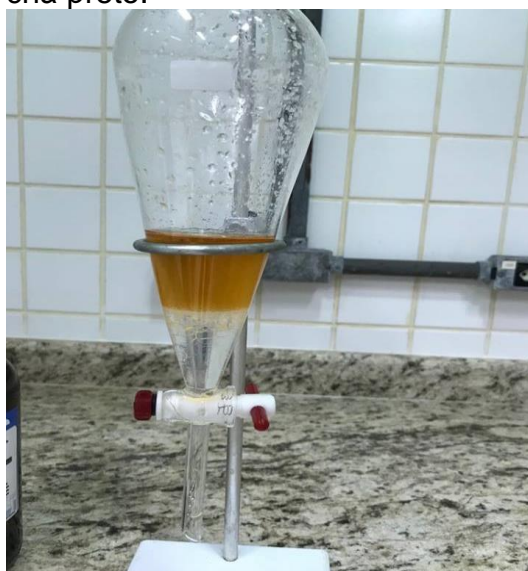
Figura 14 - Funil de separação entre a fase aquosa da fase orgânica de chá preto.
