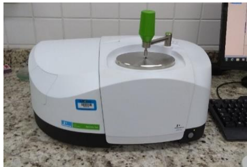
Figura 8 – Espectrômetro IV-FT modelo PerkinElmer Spectrum Two FTIR.
