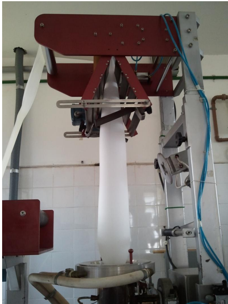
Figura 4. Matriz da extrusora com formação do filme em balão pelo processo de sopro.
