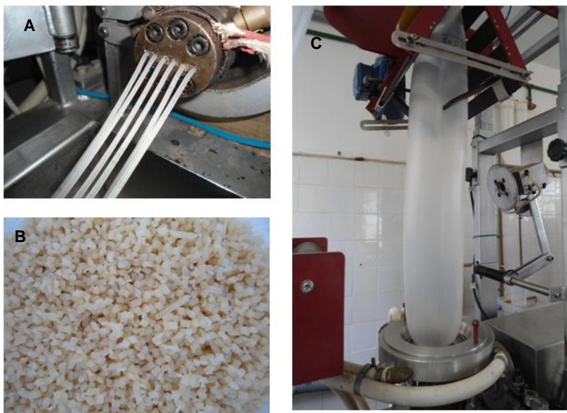
Figura 5. Etapas do processo de elaboração dos filmes. A-Peletes. B- Peletes triturados. C- Balão formado durante o processo de extrusão-sopro.
